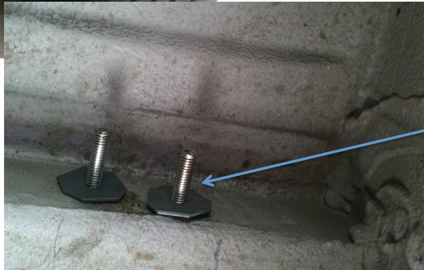
Un trou identique dans le coffre, sous le tapis, permet de faire passer les boulons de fixation
